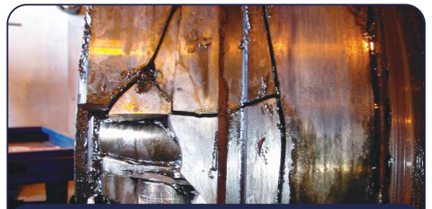
Les dommages du roulement étaient très évidents et correspondaient au profil du fichier sonore
