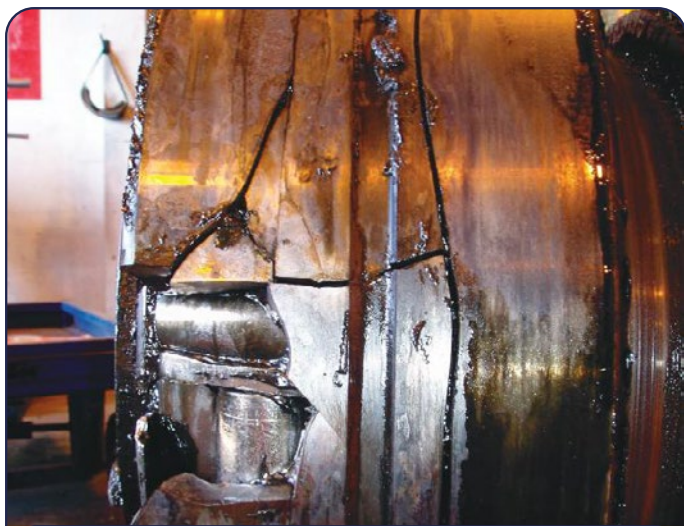
El daño del rodamiento era muy evidente y coincidía con el patrón del archivo de sonido.
