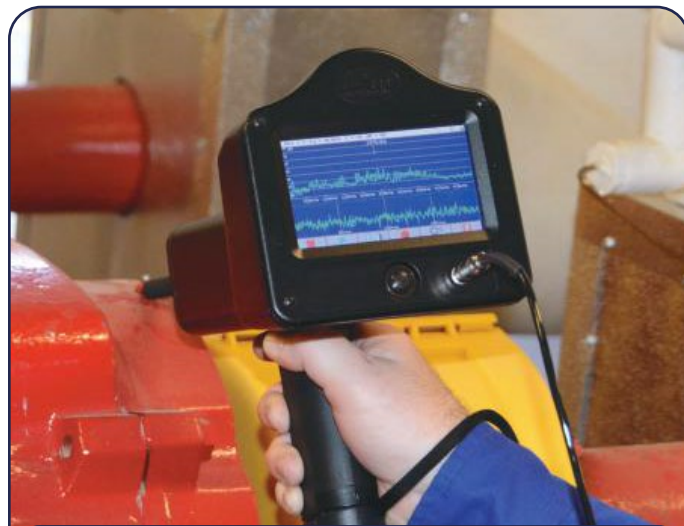
Un instrumento ultrasónico con grabación de sonido es la herramienta perfecta para supervisar el estado de los rodamientos de baja velocidad.
