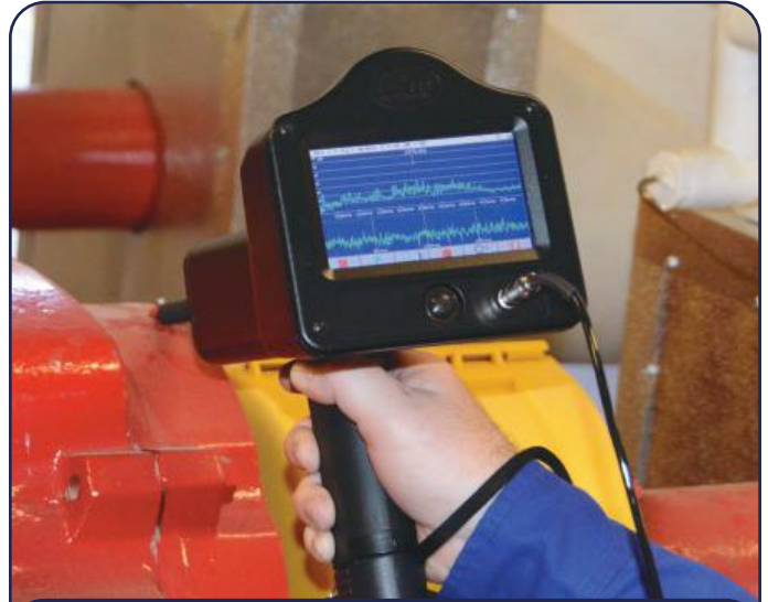
Ein Ultraschallgerät mit Tonaufzeichnung ist das ideale Werkzeug zur Überwachung des Zustands von langsam laufenden Lagern.
