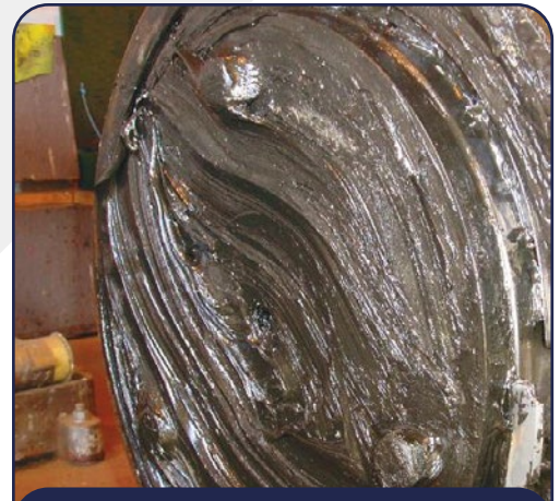
Langsamlaufendes Lager eines Ofenmotors nach dem Ausbau zum Austausch
